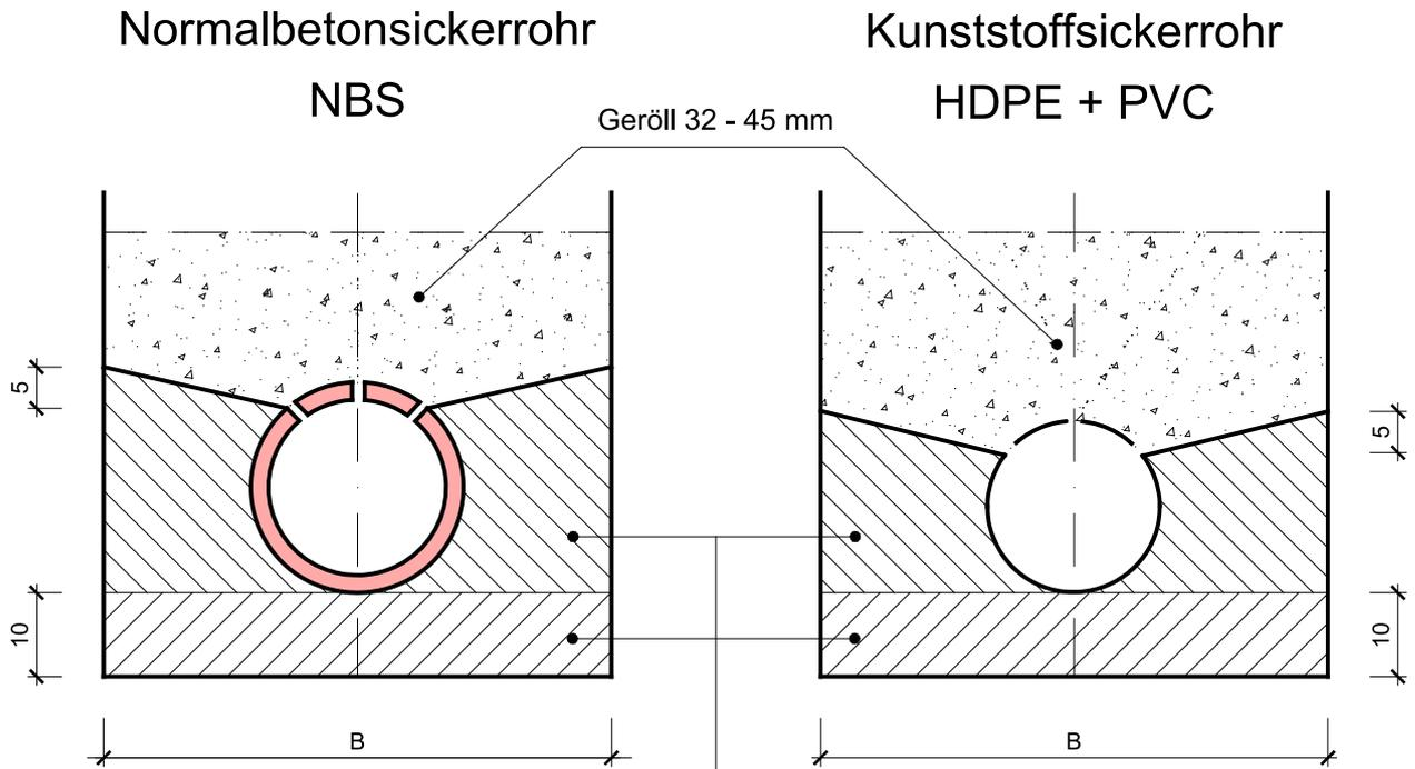
Hüllbeton: Beton 0/16 mm, CEM 200 kg/m<sup>3</sup>, C1
